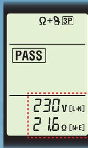
Se pueden mostrar la tensión L-N y la resistencia N-E en el sistema TT.
