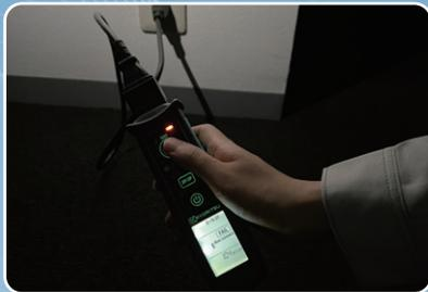
La retroiluminación LCD se enciende automáticamente en el lugar oscuro.
