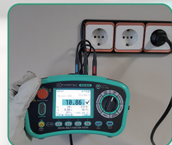
Prueba de bucle desde un enchufe de pared
