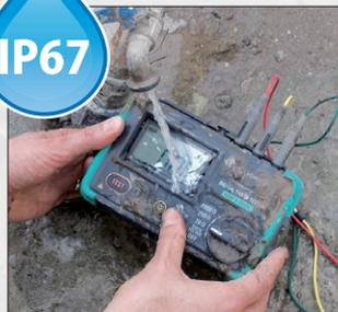
Resistente al polvo e impermeable: después de usarlo, puede lavarlo para quitar el barro y el polvo
