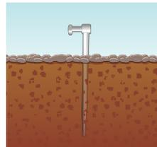
Las mediciones de tierra son posibles hasta 100kΩ\* de resistencia de las picas de tierra auxiliar.
