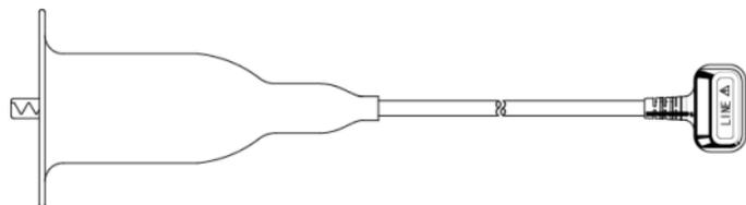
(2) MODEL7253 Sonda Line larga con pinza de cocodrilo (15 m)
