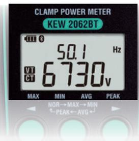
Estableciendo CT y VT y midiendo el lado secundario del transformador, se puede obtener el valor del lado primario.
